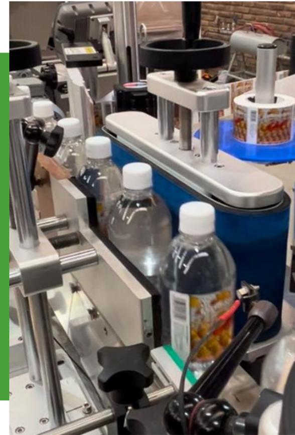
**Etiquetado envolvente, para envases cilindricos**
