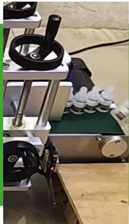
**Etiquetado envolvente, para envases cilindricos**
