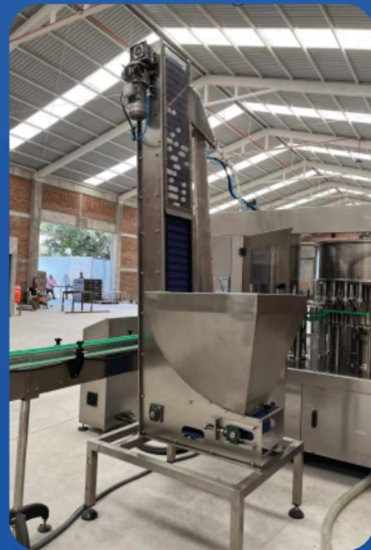
Control por PLC con ajuste de velocidad por inversor, interfase HMI táctil. Muy sencillo de manejar, modos de control automático y manual
