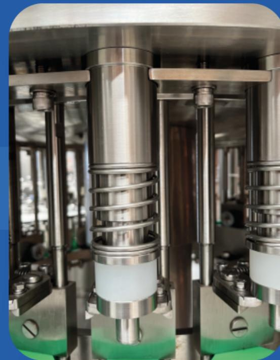
Sujeción de los envases por el cuello. Fácil acceso a la boquilla y a los manejos para cambio de formato
