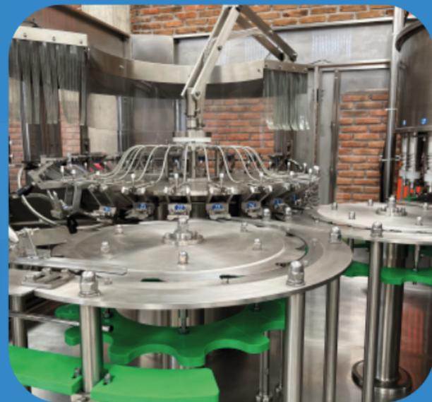
Llenado de los envases por gravedad y retorno del producto al mismo tanque. Incluye entrada de lavado CIP y válvula de purga del tanque para cambios rápidos de productos.
